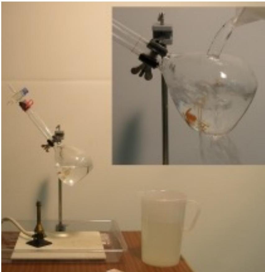
Dans l'expérience du **bouillant de Franklin**, quand l'eau refroidit, que devient la pression dans le ballon ?
