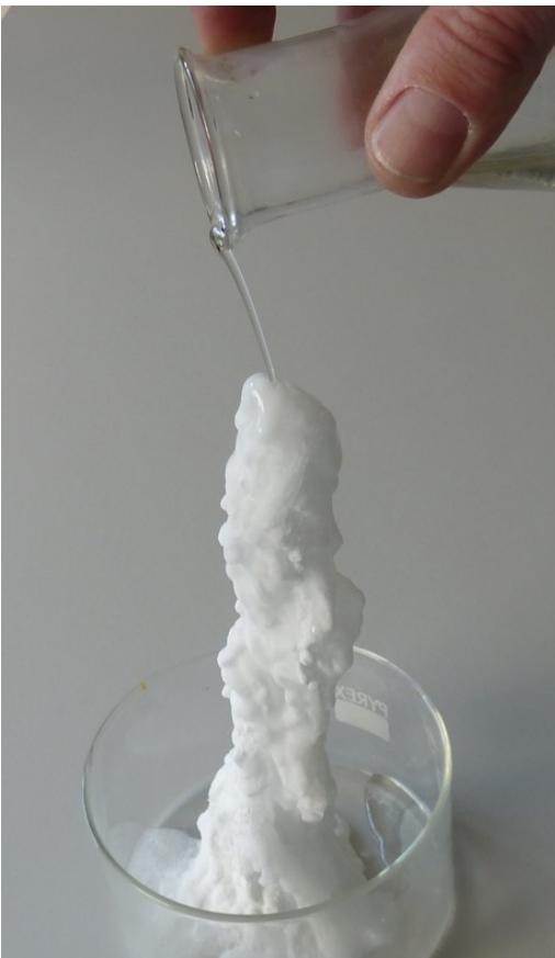
**Acétate de sodium.** La température de fusion est de 58° C à la pression atmosphérique et celle de son point triple est de 123° C. Il est en surfusion à la température ambiante 20° C. Sous l'effet d'un choc le fluide va se solidifier.
